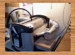
A GOOD GROUNDING SYSTEM SHOULD BE INSTALLED WITH YOUR DUST COLLECTION SYSTEM AS STANDARD PRACTICE TO INSURE STATIC ELECTRICITY DOES NOT OCCUR.
